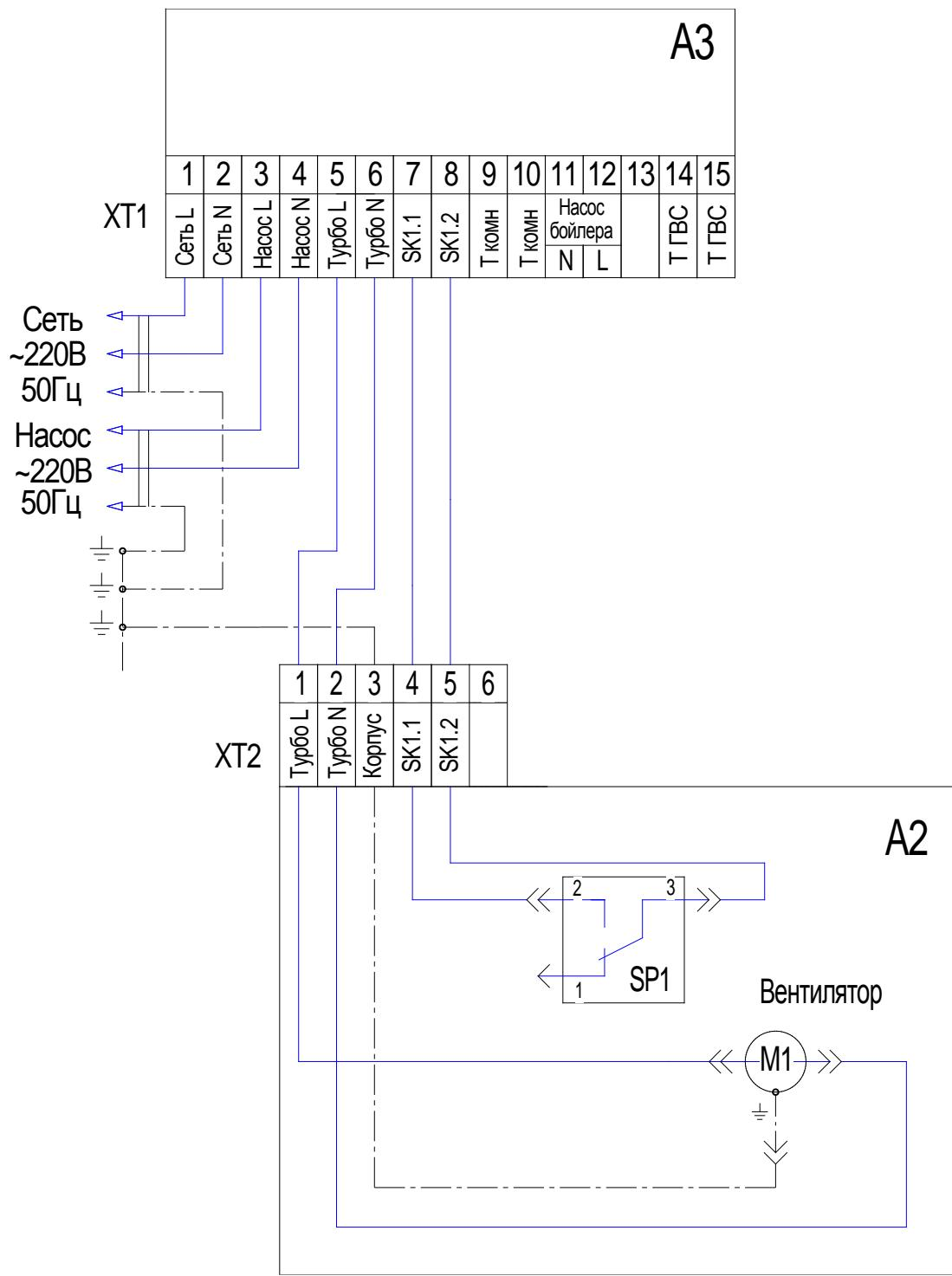
A2 – Турбонасадка ТН; A3 – Котел „Изнаир А“ с жидкокристаллическим дисплеем;
