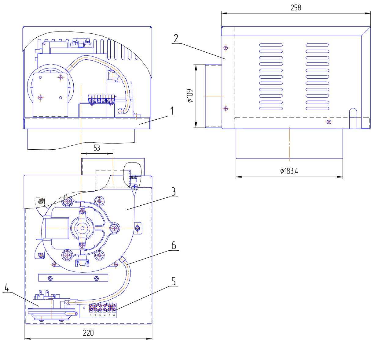
1–Основание; 2–Кожух; 3–Вентилятор; 4–Прессостат; 5–Клеммная колодка; 6–Трубка соединительная.
