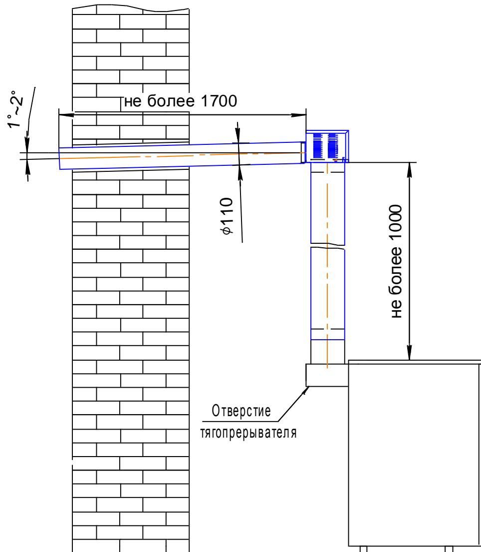
Рисунок 7. Присоединение к трубе, выходящей на улицу
