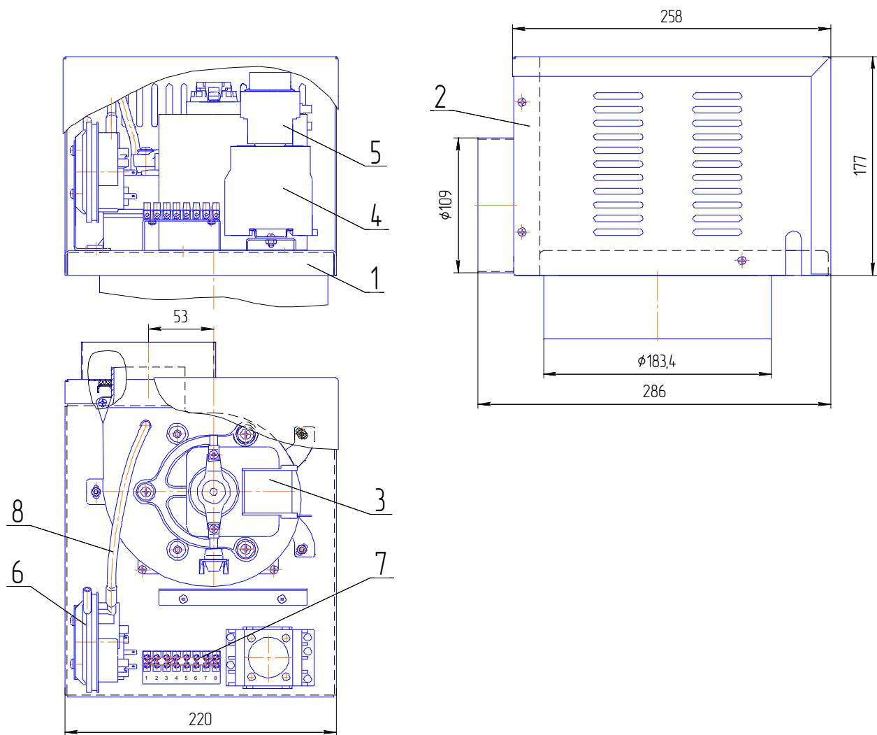
1–Основание; 2–Кожух; 3–Вентилятор; 4–Контактор малогабаритный;
