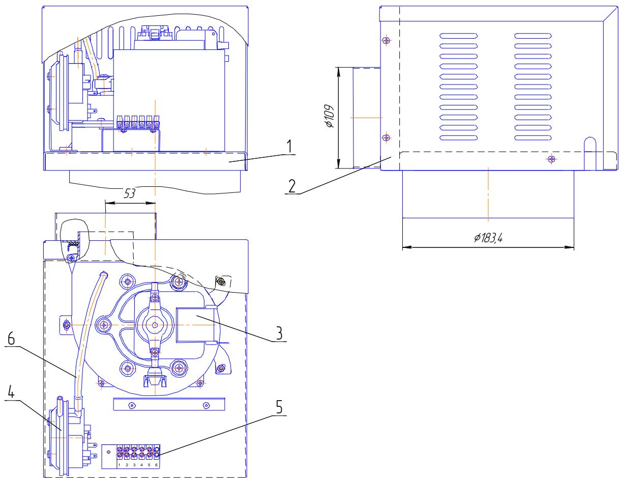
1–Основание; 2–Кожух; 3–Вентилятор; 4–Прессостат; 5–Клеммная колодка; 6–Трубка соединительная.
