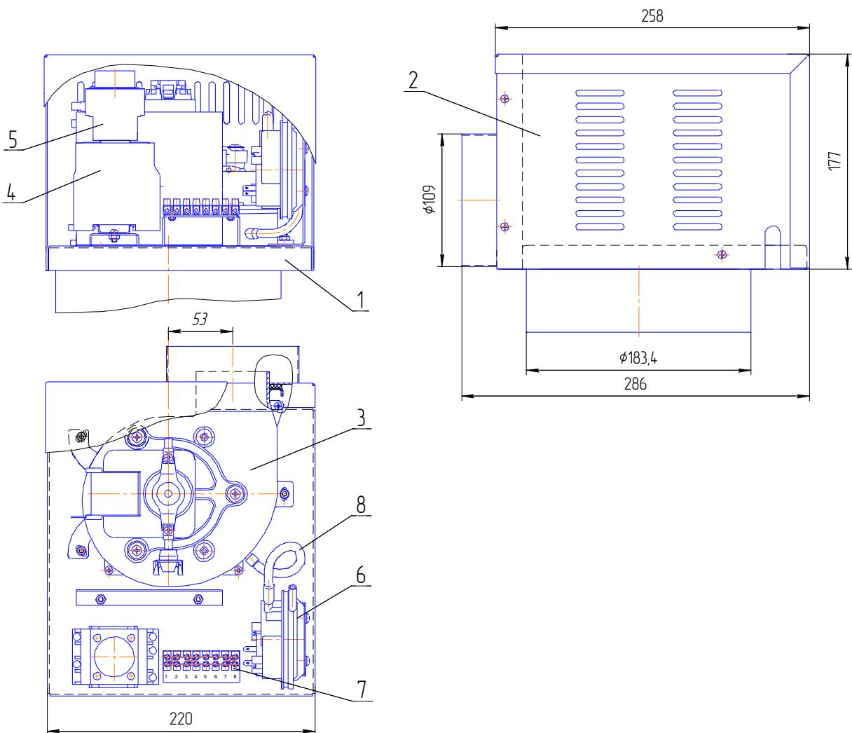
1–Основание; 2–Кожух; 3–Вентилятор; 4–Контактор малогабаритный;
